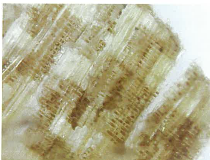
Fig. 1 Proba 2 Lemn talpă catapeteasmă:Foto 1 secțiune transversală, Foto 2 secțiune tangențială, Foto 3. secțiune radială, OMx500
